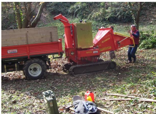
Foto 21. Ma per triturare la ramaglia servono macchinari costosi e che non possono andare ovunque. Questo modello è uno dei più piccoli, altri sono più grandi e sono trainati da trattori. (foto Enzo Mauri)
