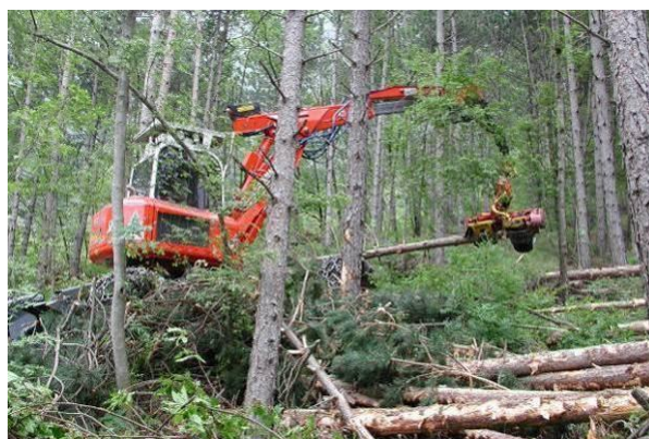
Foto 63. Macchina operatrice per la raccolta, la sramatura e la depezzatura del legname in bosco in Valtellina. La macchina permette di ridurre molto i costi della lavorazione del legname, tuttavia necessita di un'accessibilità al bosco su strada. (foto Tiziana Stangoni)
