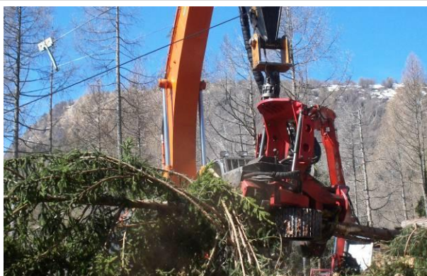
Foto 64. Macchina operatrice (processore) per la sramatura e la depezzatura del legname. Valvarrone. (foto Roberto Tonetti)
