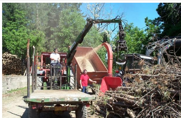
Foto 65. Cippatrice al lavoro in Valtellina: è evidente che si può operare solo su strada o in prossimità di essa! (foto Tiziana Stangoni)
