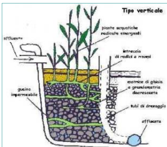
Figura 4: sistema a flusso sub-superficiale verticale - schema di funzionamento
